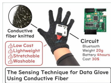
研究例② Groov: 導電繊維を用いた安価かつ多彩なデータグローブ
